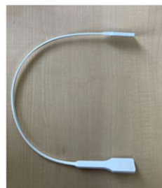
引張試験(試験後)
